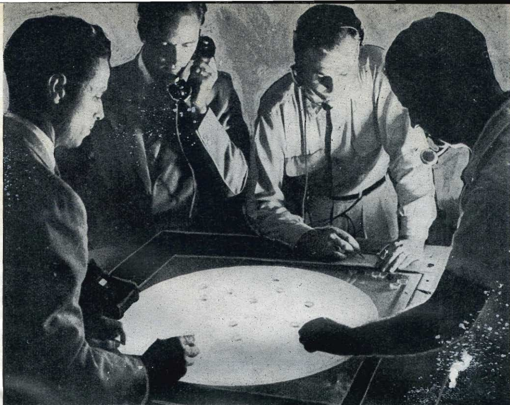
A scopo sperimentale le immagini dello schermo radar sono proiettate su un vetro piano e orizzontale
