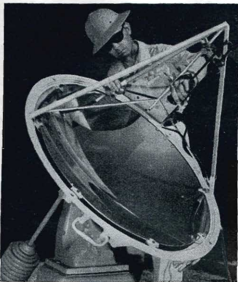
Questo apparecchio produce impulsi mediante cicli alternati di acqua in ebollizione e vapore condensato
